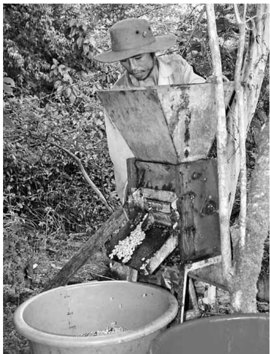
水洗加工時の果肉除去の様子。手動でローラーを回す場合と、モーターで回す場合がある。
