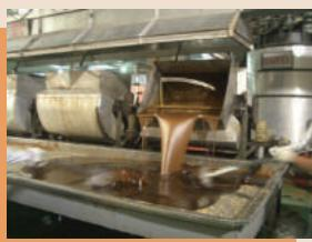
ステンレス製の閉鎖釜
